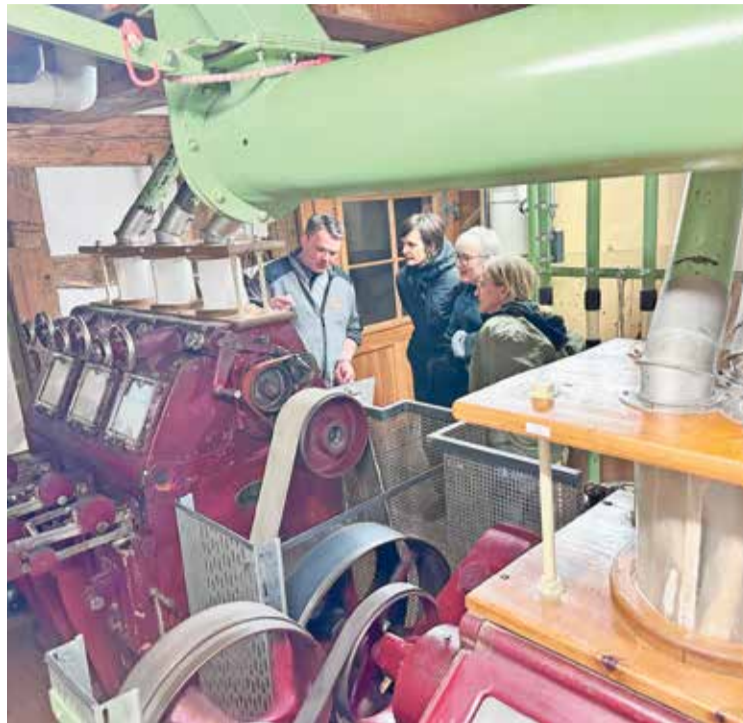
Bruno Grunder (links) erklärt das Soder-Mahlwerk, dessen Mahlsteine die letzten Mahlgänge durchführen.
